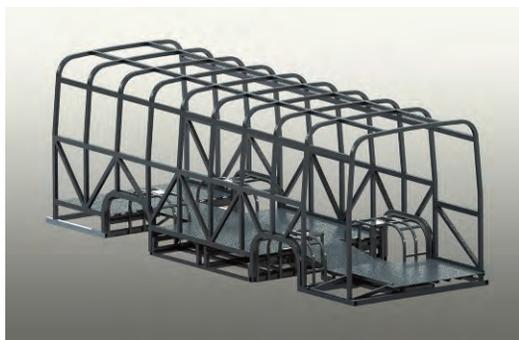
Structure monocoque minibus transport adapté
